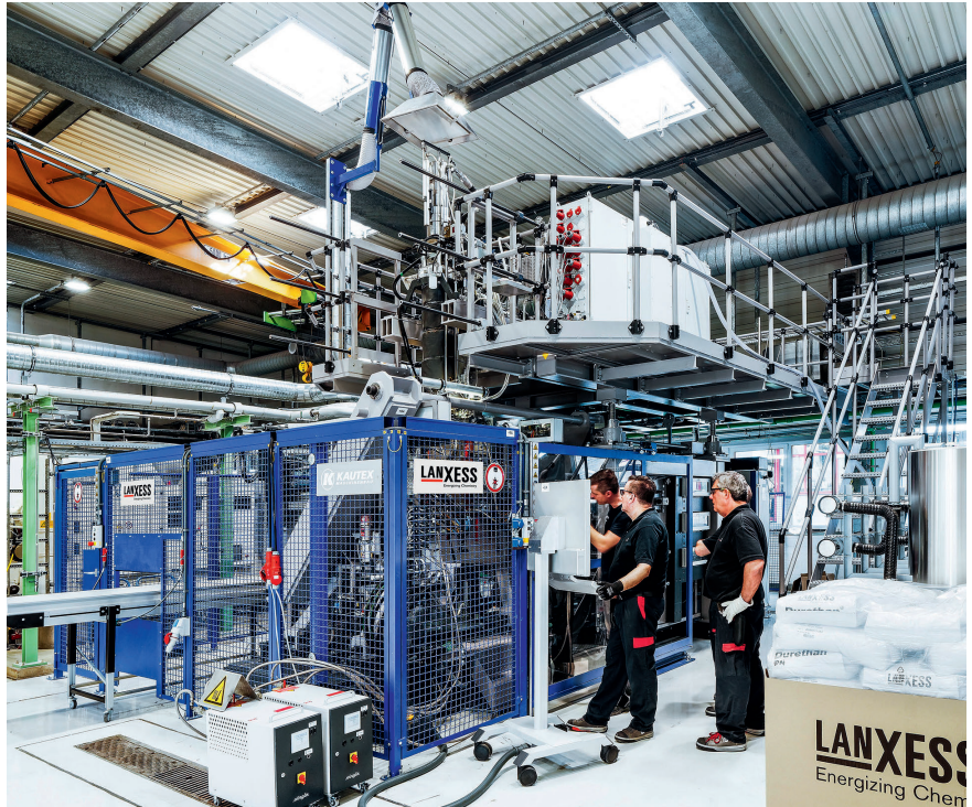
Bild 5. Mit Extrusionsblasformmaschinen werden Bauteile aus PA-6- und PA-66-Compounds hergestellt, zum Beispiel für aufgeladene Verbrennungsmotoren (© Lanxess)
